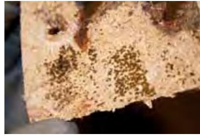
Lastulevyn pinta on saanut kosteutta. Kosmeettisista syistä myös vahingoittumattomia lastulevyjä vaihdettiin gyprok- eli kipsilevyihin.
